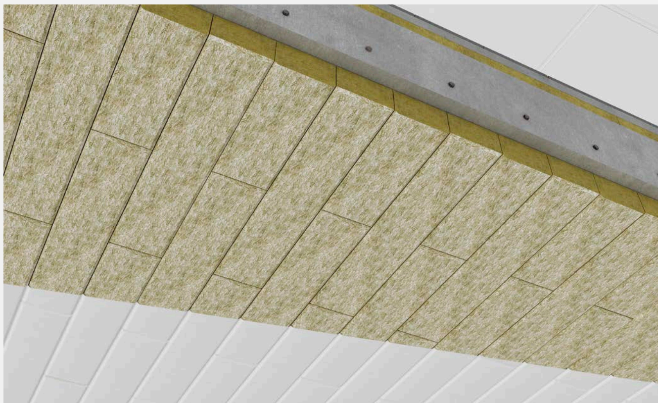
Przewiązanie płyt w połowie płyty.
